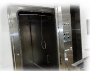
真空冷却機 (ゆでた野菜を短時間で冷やす)
