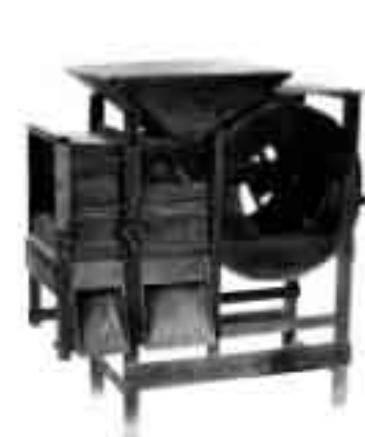
唐箕は、風力を利用して穀物を精選（実の入った粗穀や稻穂などのごみをより分けたり、十分実った穀と未熟な穀を識別）する道具として造られました。中国から伝わったとされ、中国では風扇車と呼ばれていました。円筒形の風扇の内部にある羽根を回転させて風を起こし、その風力で風扇の上に据えてある漏斗状から落ちてくる粗穀を吹き飛ばすもので、重い米粒は一番口、未熟な米粒は二番口、軽いワラやごみは大口と三つに選別されてそれぞれの口から出でくる仕組みとなっています。しかし、風をあまり強くするとよい実まで飛ばしてしまい、逆にあまり弱いと選別の状態が悪いので、いつも下の口を見ながら風力を調整して回転させなければなりません。唐箕は時代とともに改良されました。
